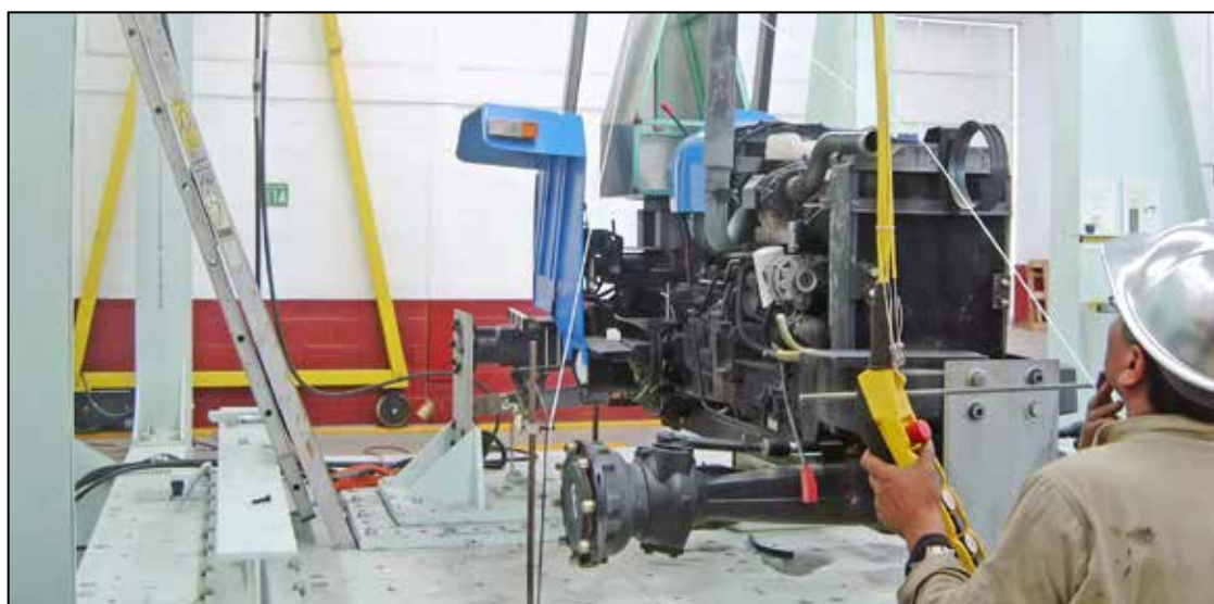
Pruebas técnicas y ensayos de un tractor agrícola, cumpliendo los requisitos de la norma NMX-O-207-SCFI-2016, como parte del proceso de certificación. CIMA
