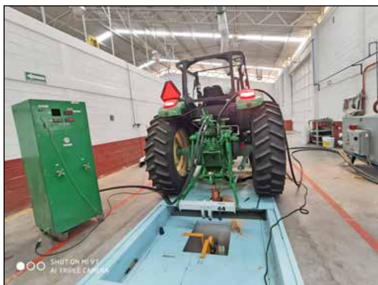
Pruebas técnicas y ensayos de un tractor agrícola, cumpliendo los requisitos de la norma NMX-O-207-SCFI-2016, como parte del proceso de certificación. CIMA
